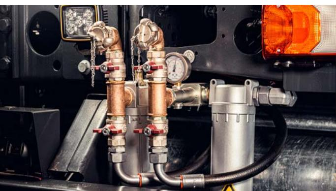
Kompressor Qmax = 4,5 m<sup>3</sup>/min, Pmax = 7 bar über Funk schaltbar
